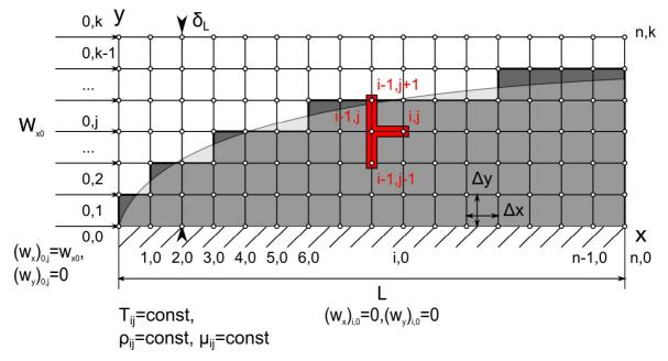
Высоту расчётной области можно определить из оценок толщины пограничного слоя при ламинарном режиме течения:
